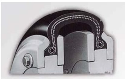
Figura 3. Vista parcial de un acople flexible de diseño especial.
