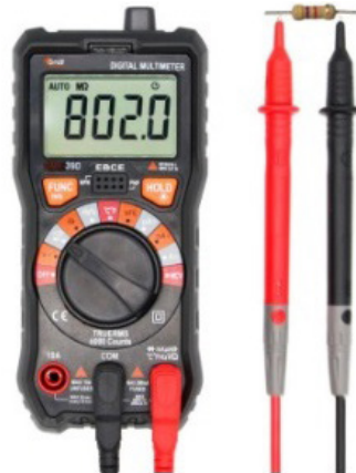
Figura 3. Medición de resistencia con Multímetro GMF-39D
