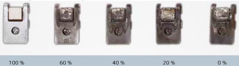
Foto 2. Ejemplo de desgaste de los contactos principales de un contactor
