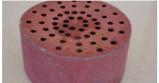
Figura 5. Cubre ventilador mal construido
